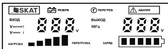
Рисунок 3 — Светодиодный графический индикатор.
